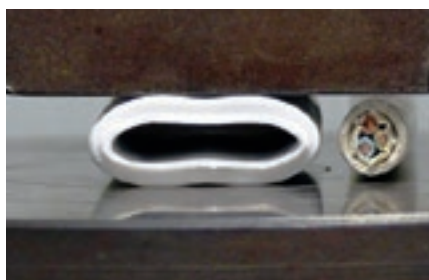
Verformung 50 % „biegsam, sich selbst zurückbildend“
